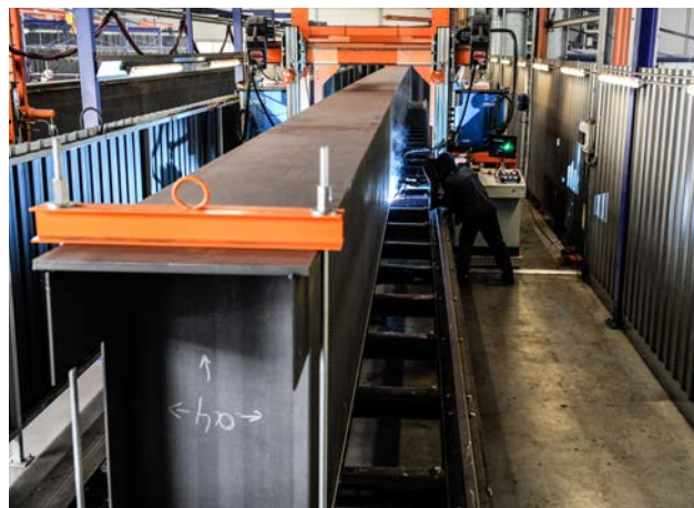
Teil des Maschinenparks der Haslinger-Gruppe ist eine Längsnahtschweißeinrichtung, mit der Hallenkran-Kastenträger bis zu einer Länge von 36 Metern prozesssicher beidseitig verschweißt werden
