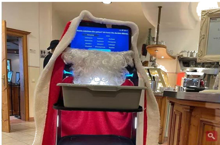
Der Servicroboter kann mehrere Tablets auf einmal transportieren und so dem Personal Laufwege abnehmen. // Foto: Jürgen Gärtner
